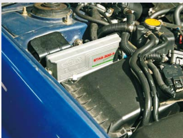
Rys. 6 Zalecana pozycja zamontowania sterownika gazu
