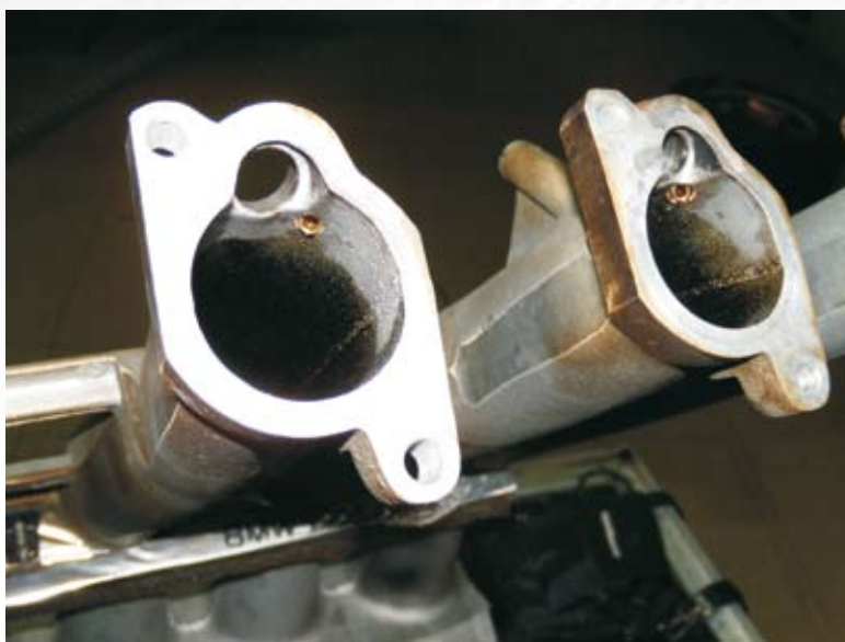
Rys. 5 Poprawnie wkręcone dysze w kolektor ssący
