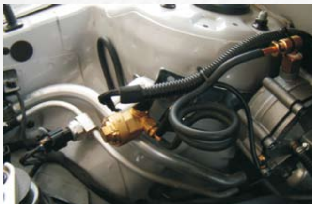
Rys. 7 Umieszczenie elektrozaworu blisko reduktora
