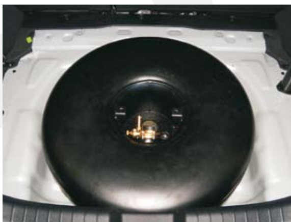
Rys. 9 Zbiornik w miejscu koła zapasowego
