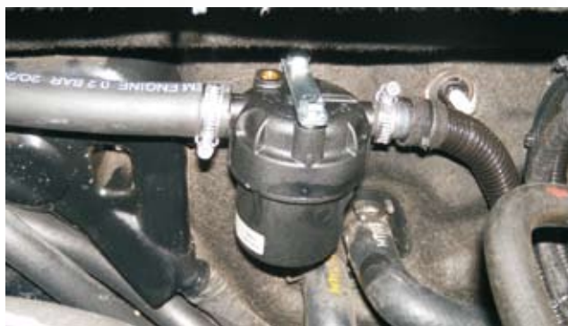
Rys. 12 Filtr fazy lotnej powinien być przymocowany
